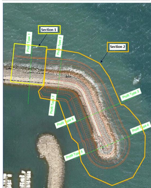
Figure 7 : Vue en plan des sections à renforcer
