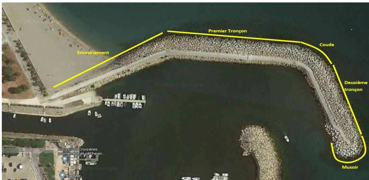
Figure 7 : Vue en plan des sections à renforcer
