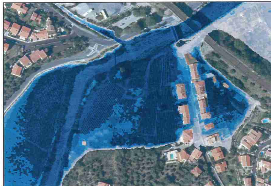
Illustration des débordements de la Baillaury sur le secteur de la Martine Basse pour une crue d'occurrence trentennale (Q 30 )
