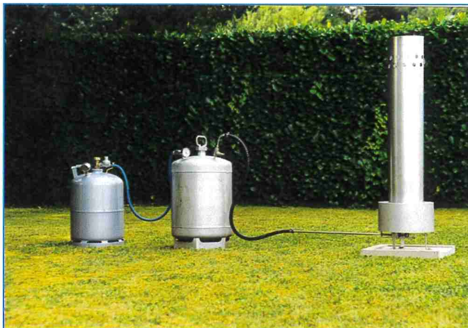
Poste diffuseur d'iodure d'argent complet.
