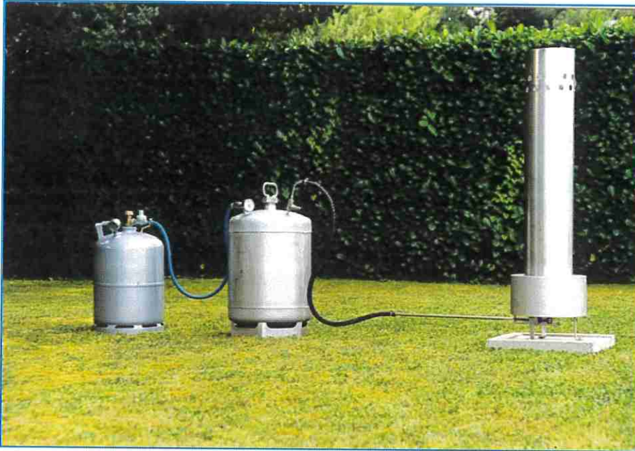
Poste diffuseur d'iodure d'argent complet
